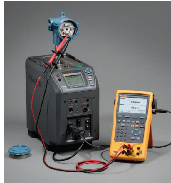
图 5. Fluke 754 和福禄克计量校准部干井，校准 4-20 mA 变送器和温度传感器。
